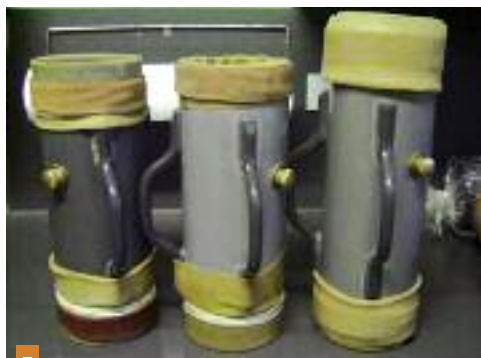
5 Adapter la longueur du tube à celle de la verge de l'étalon.
