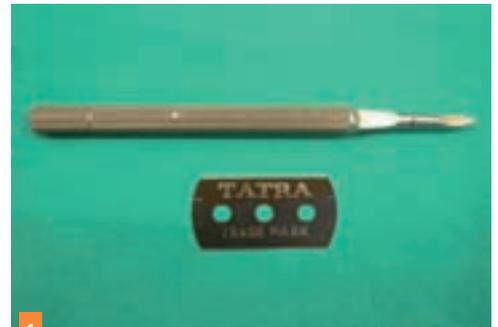
1 Porte-lame de Troutman sur lesquels on monte des lames de rasoir sécables (photos T. Azoulay).
